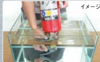
従来の消火器 (水による気密試験)
